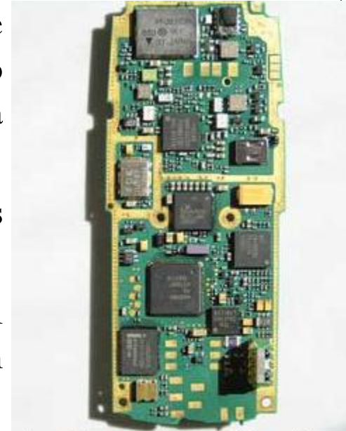
Los metales que contiene un teléfono móvil se concentran en los componentes del circuito integrado
